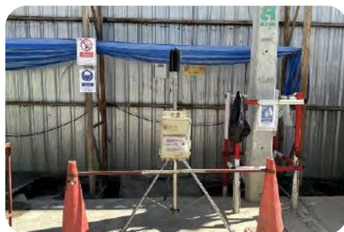
การตรวจวัดระดับเสียงทั่วไป บริเวณพื้นที่ก่อสร้างโครงการและพื้นที่โดยรอบ
