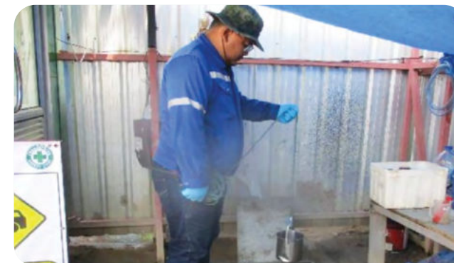
จุดตรวจวัดคุณภาพน้ำถึง บริเวณบ่อพักน้ำสุดท้ายก่อนระบายออกจากโครงการ
